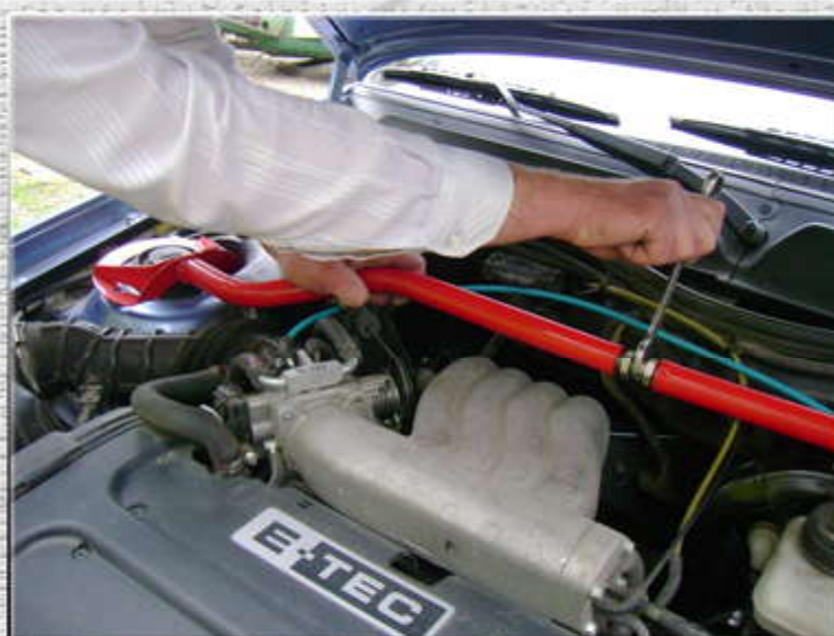
5.Регулируя длину усилителя жесткости скручивать стяжку (ключом) до тех пор пока отверстия на правой части усилителя жесткости не совпадут со шпильками на правой стойке (стакане, чашке);
