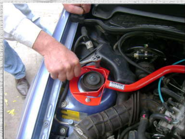
6.Закрутить на правой стойке (стакане, чашке) две гайки M8;
