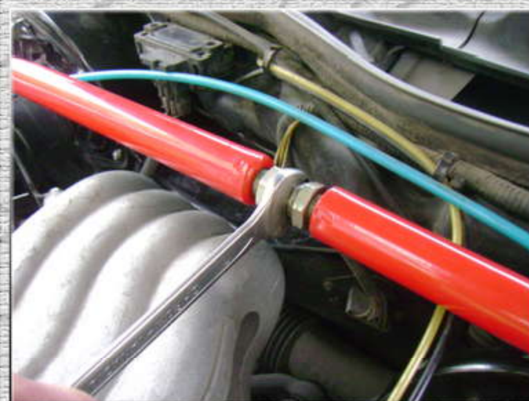
9. Разжать усилитель жесткости регулировочной шпилькой (стяжкой) с силой \approx 5 \text{ кг} \cdot \text{с/м}
