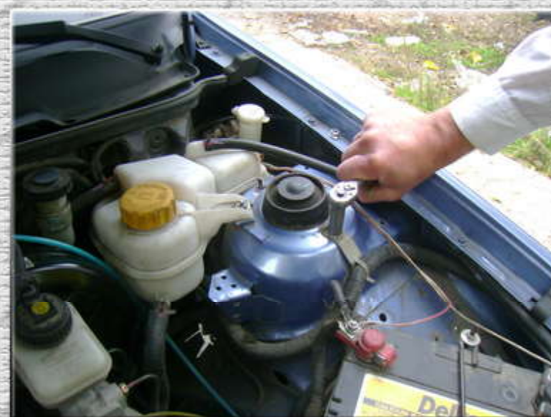
3.Открутить на левой стойке (стакане, чашке) две гайки M8;
