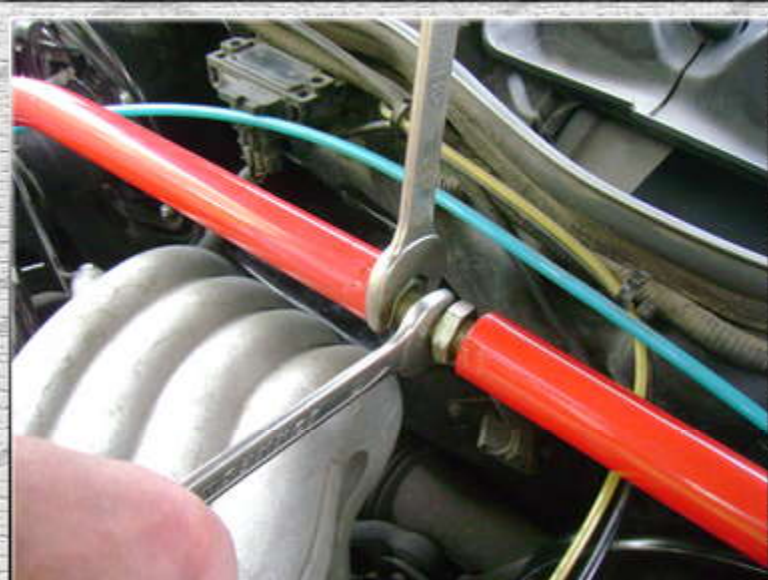
10. Зафиксировать размер усилителя жесткости контрящими гайками на регулировочной шпильке (стяжке) сначала правой....;
