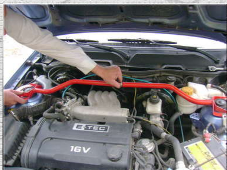
4.Посадить левое кольцо усилителя жесткости на шпильки левой стойки (стакана, чашки);
