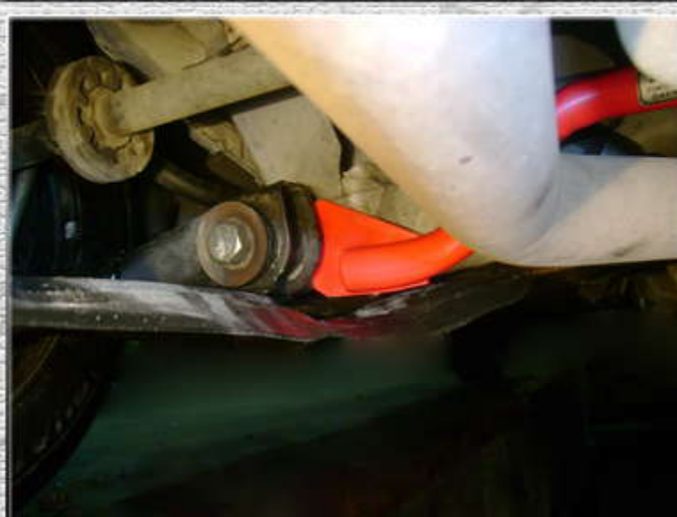
11. Одеть правую часть усилителя жесткости на правый болт рычага, между шайбой сайлент-блока и кузовом автомобиля;
