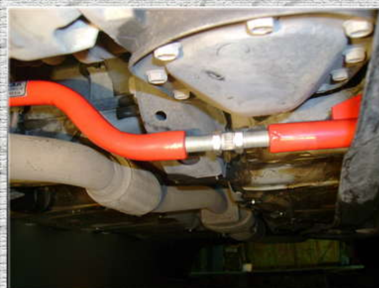
9. Совместить правую и левую части усилителя жесткости, и ввернуть стяжку
