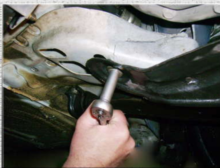
5. Открутить болт крепления защиты;
