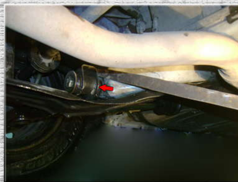
3. Монтировкой отодвинуть правый рычаг от кузова, приблизительно на 5 мм;
