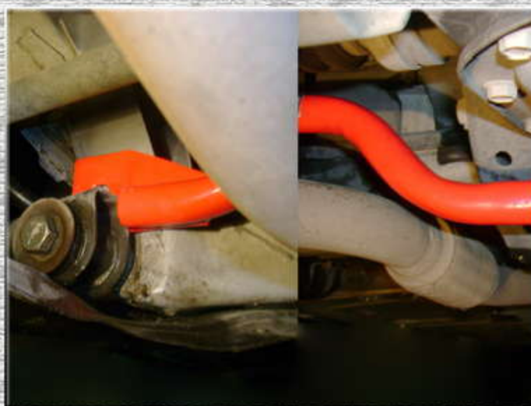
8. Завести правую часть усилителя жесткости над глушителем и правым болтом рычага;
