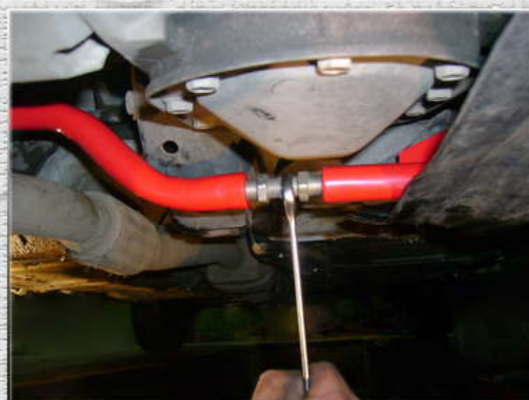
15. Скрутить усилитель жесткости регулировочной шпилькой с усилием в 5 кгс м;
