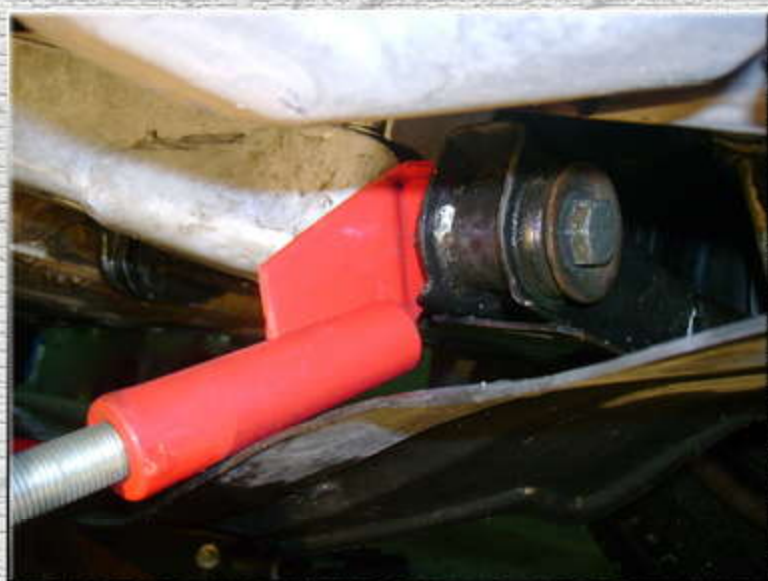
7. Надеть на левый болт рычага левую часть усилителя жесткости;
