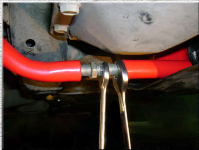
16. Зафиксировать размер усилителя жесткости правой контрящей гайкой на регулировочной шпильке (стяжке);
