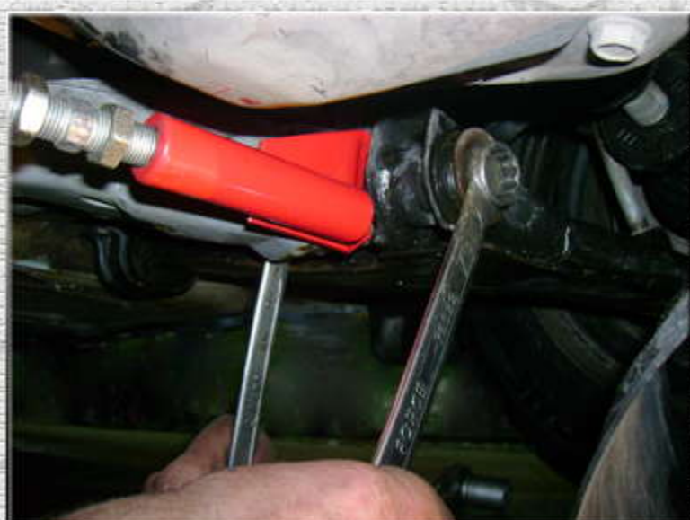
13. Закрутить гайку левого болта рычага;
