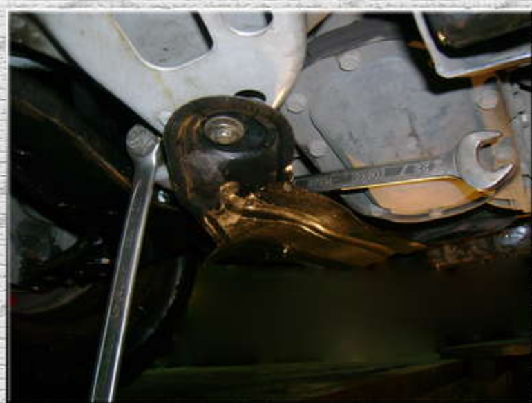
1. Открутить гайку левого болта рычага на несколько витков;
