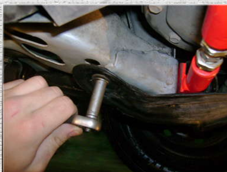
14. Закрутить винт крепления защиты;
