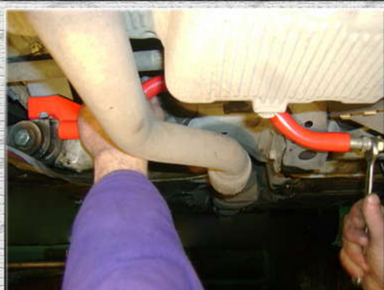
10. По мере вкручивания стяжки правое ухо усилителя жесткости совместится с правым болтом рычага;
