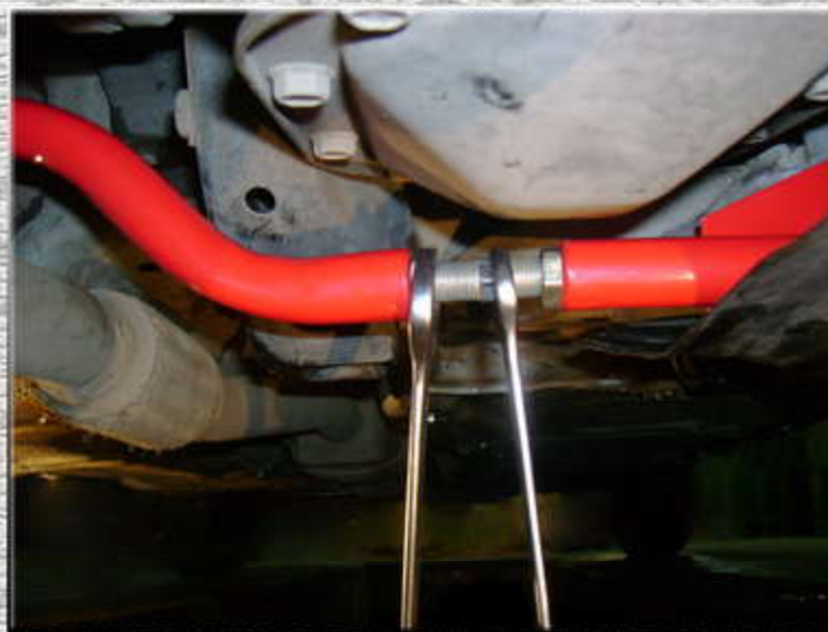
17. Зафиксировать размер усилителя жесткости левой контрящей гайкой на регулировочной шпильке (стяжке);
