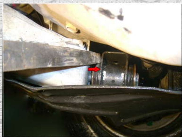
4. Монтировкой отодвинуть правый рычаг от кузова, приблизительно на 5 мм;
