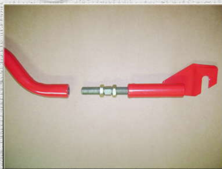
6. Раскрутить усилитель жесткости на две части;
