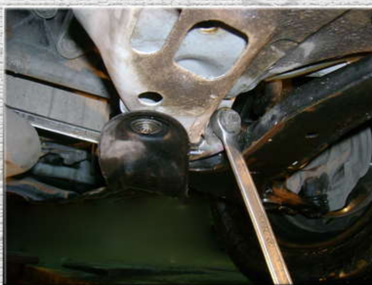
2. Открутить гайку правого болта рычага на несколько витков;
