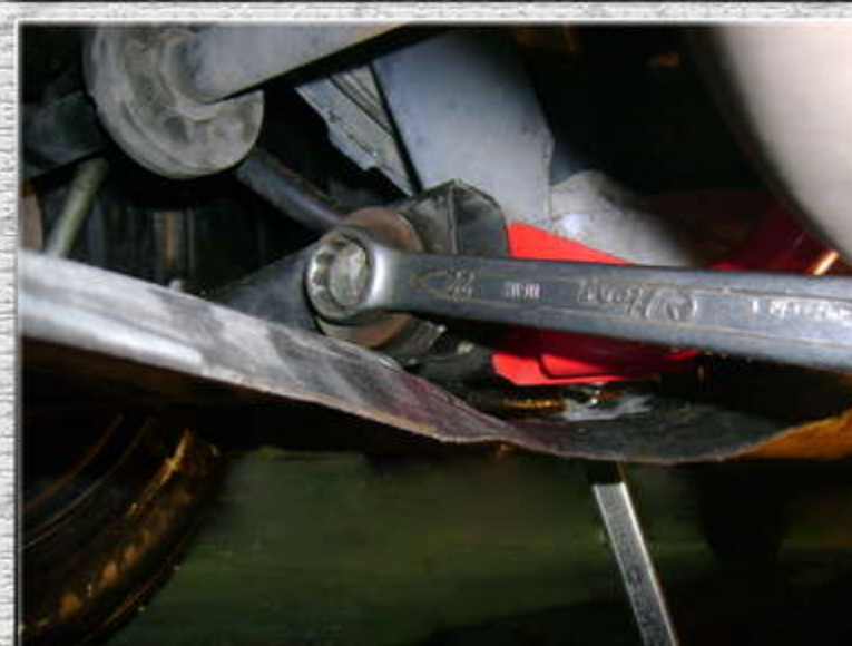
12. Убедиться в том, что усилитель жесткости сел в пазах на болты рычагов и закрутить гайку правого болта рычага;
